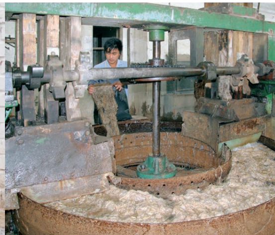
mechanische Aufbereitung der Fasern nach dem Kochen
